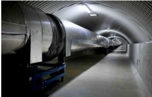
Le tube à vide nord de Virgo, d'un diamètre de 1,2 m (crédits : Collaboration Virgo).
