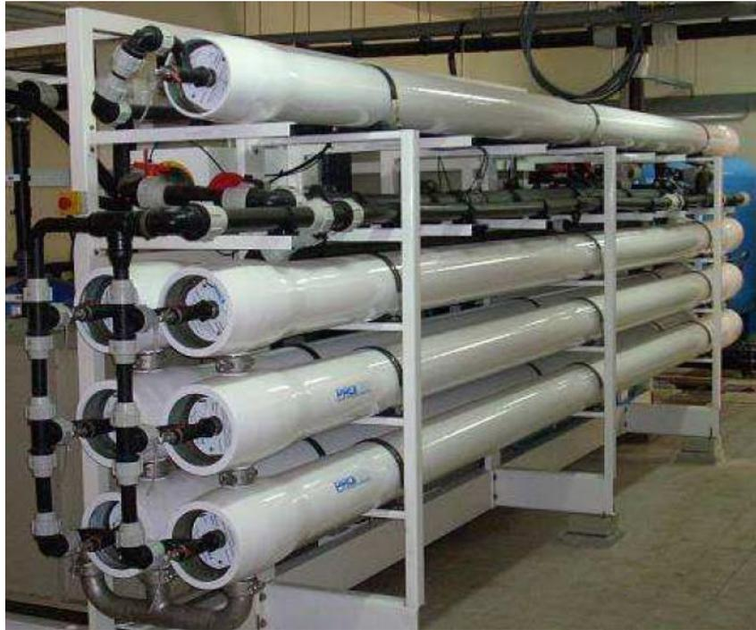
*Photo de plusieurs « étages » recevant les modules de membranes semi-perméables.*
