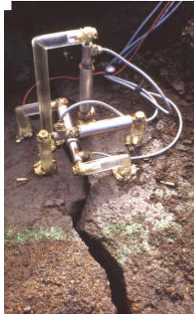
avec ces extensomètres des variation de 1/100 de millimètre.
