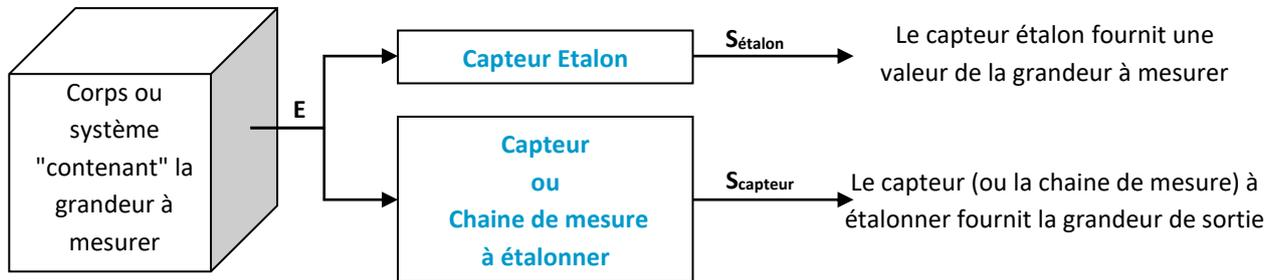
Le capteur étalon et le capteur (ou la chaîne de mesure) à étalonner sont soumis à la même grandeur à mesurer
