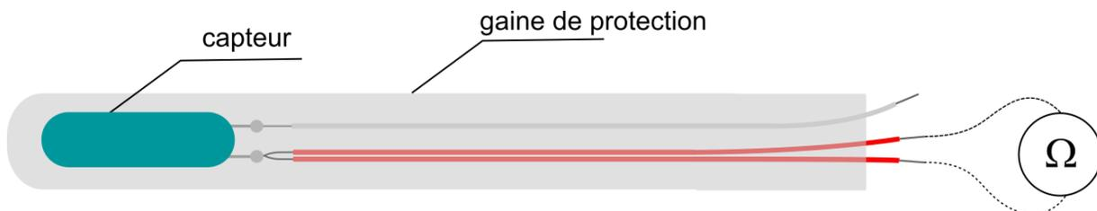
Schéma de la sonde Pt100 3 fils et mesure de la résistance des fils de connexion
