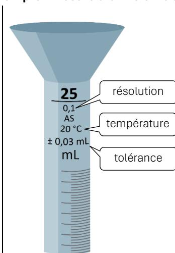
Considérons 3 sources d'erreur : la résolution de l'instrument, la tolérance fabricant et la variabilité de la température. Supposons que la température varie de 3°C maximum par rapport aux 25°C préconisés par le fabricant.
