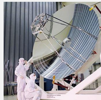
Miroir primaire du télescope spatial Herschel (source : esa.int)
