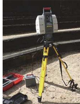
Le LiDAR est muni, entre autres, d'une sonde constituée d'un émetteur et d'un récepteur d'impulsions laser. Lors de la mesure d'une distance :
