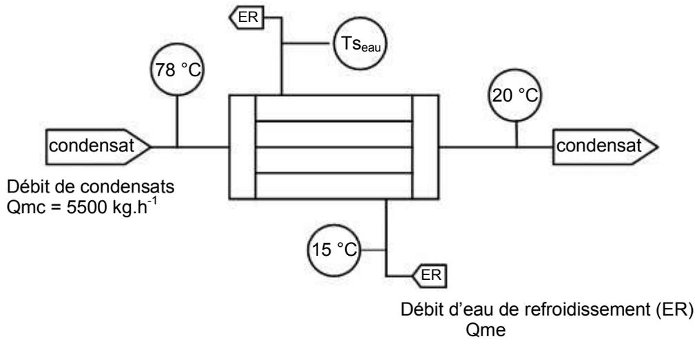
**Données :** Chaleur massique des condensats :  $C_{p_c} = 2,51\text{ kJ}\cdot\text{kg}^{-1}\cdot\text{K}^{-1}$ .
