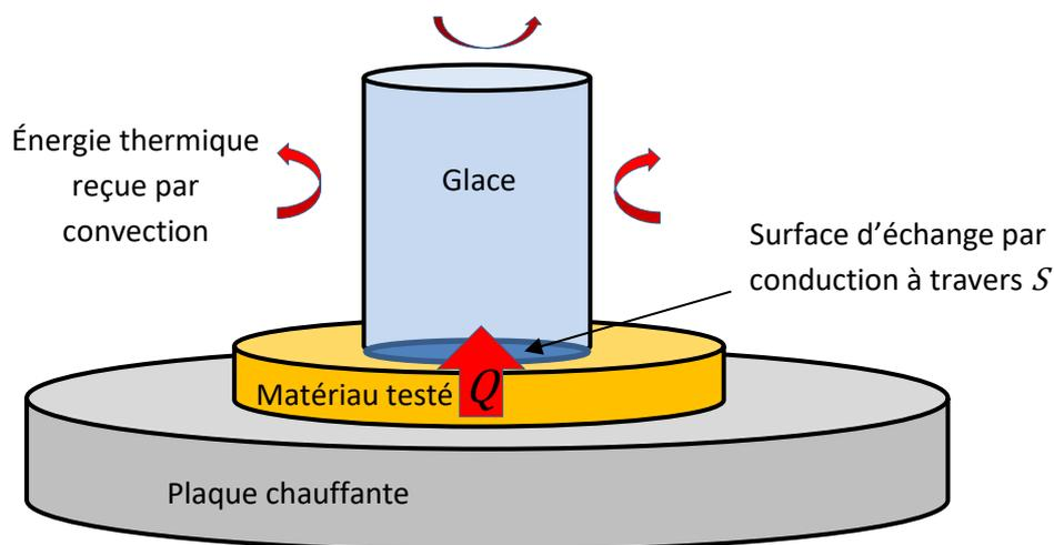
La mesure de la masse de glace qui a fondu nous renseigne sur l'énergie thermique échangée, notée  $Q$  dans la suite. La connaissance de  $Q$  et de la durée  $t$  de l'expérience permet de calculer la puissance thermique  $P_{th}$  reçue par la glace à travers le matériau :
