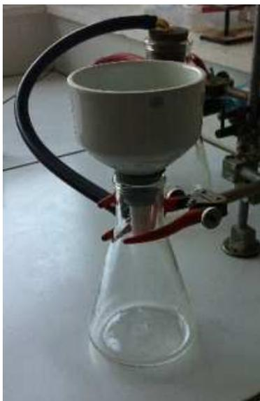
Transvaser de façon quantitative le filtrat dans une fiole de 50 mL. Ajuster au trait de jauge avec le solvant. Soit <S> cette solution.
