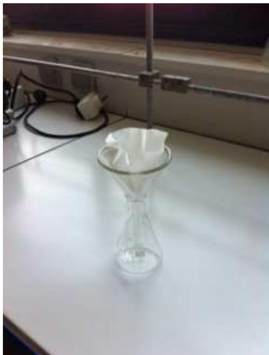
Transvaser le filtrat dans une fiole de 50 mL. Ajuster au trait de jauge avec le solvant. Soit <S> cette solution.
