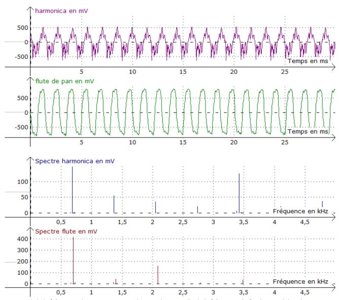
La mesure de la fréquence des signaux temporels coïncide avec celle de la fréquence du fondamental dans le spectre et est voisine de 659 Hz (fréquence du Mi). On remarque dans cet exemple que la flute de pan donne un Mi légèrement plus aigu que l'harmonica. Cela peut venir d'un mauvais accord de l'un des l'instruments comme de l'instrumentiste...
