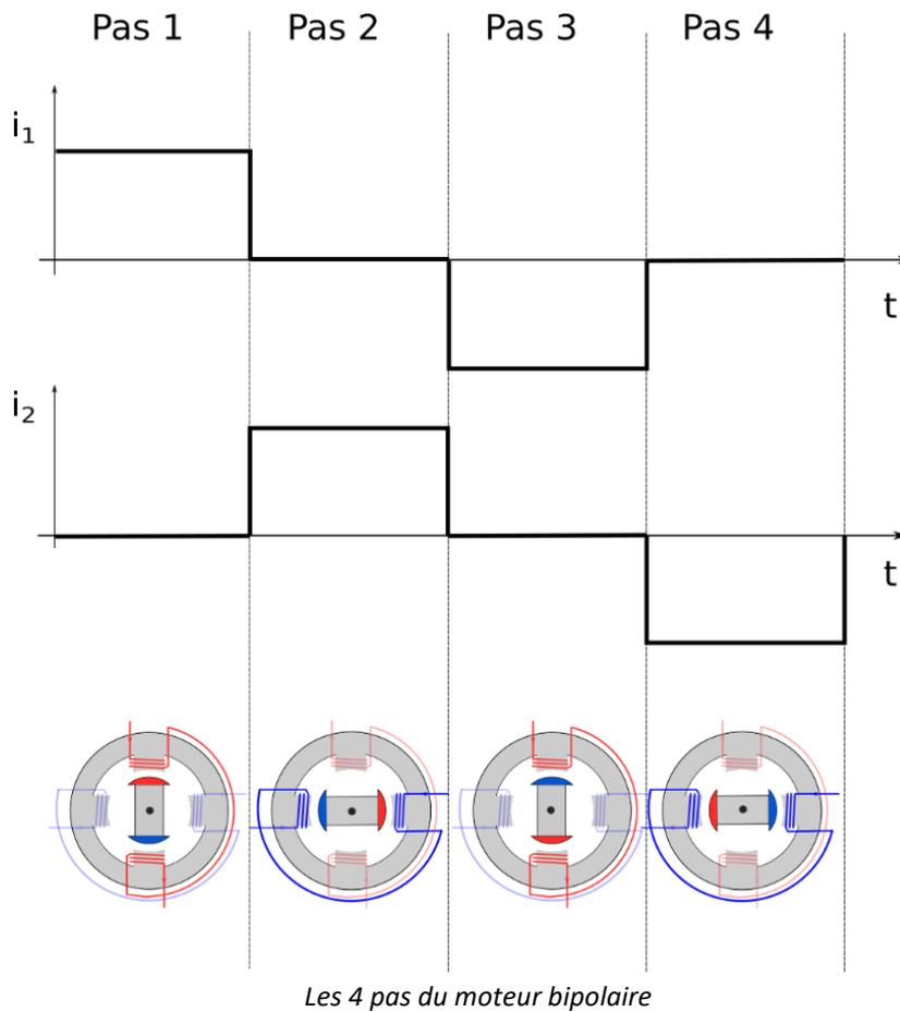
L'aimant a donc 4 positions possibles par tour. On dit que l'angle de pas, ou le pas est de  $90^\circ$ . On a donc un moteur pas à pas de 4 pas par tour.
