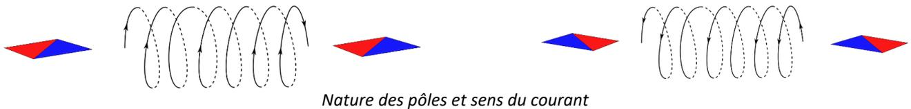
Les deux extrémités de la bobine présentent des pôles magnétiques différents dont la nature peut être déterminée en fonction du sens du courant.
