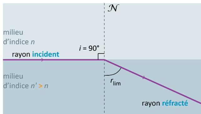
$r_{lim}$  est l'**angle de réfraction limite** : c'est la valeur maximale que peut prendre l'angle de réfraction.
