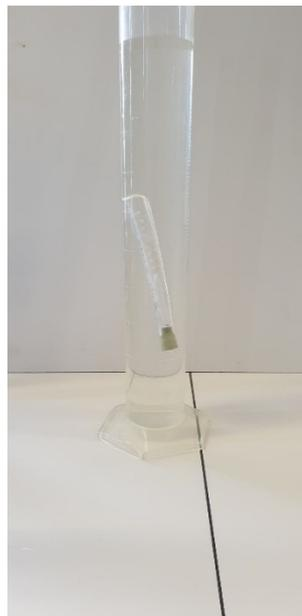
Lorsque le ludion est mis à l'eau avec la pipette en position B, le volume du ludion change mais la masse reste identique. Le ludion coule car  $F_a < P$ .
