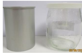
A droite, pycnomètre « pot de yaourt » et à gauche pycnomètre de laboratoire
