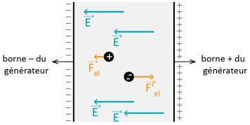
Cette figure illustre que le champ électrostatique est uniforme dans le condensateur et que la force électrostatique exercée sur une particule est de même sens que  $\vec{E}$  si la particule est chargée positivement, dans le sens opposé sinon.
