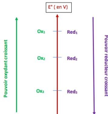
Positionner les deux couples sur une échelle de potentiel
